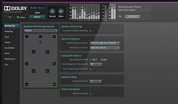
これが Atmos の心臓部となります。ソフトウェアベースで動作するこのツールは Pro Tools |HD 12.8 と同一 Mac 上にインストールし、Dolby Renderer Send/Return プラグインを使用して Pro Tools |HD と内部接続する形で使用します。Atmos ミックスを行っている間でも、Pro Tools からそのオーディオ及びメタデータを受信し、マルチチャンネル・スピーカー出力するのですが。。。なんとバイノーラル・ヘッドフォン出力も可能となり、コンパクトな環境であっても仮編集のような作業はおこなえてしまうのです。また部屋のシステムに合わせたスピーカーレイアウトを作ることになりますので、9.1.4ch や、天井を抜いた 9.1.0、5.1.2 など…スピーカーの数に制限があったとしても適切な音声配置をこの Renderer でリアルタイムに計算し出力することが可能となります。当たり前ですが…スピーカー配置をしていない場所からの音声出力はされません…。
